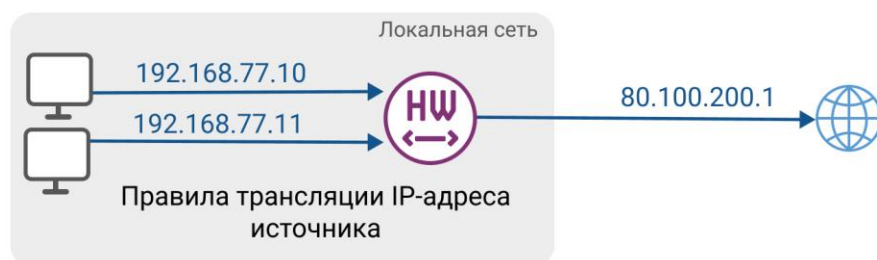
Рисунок 47. Организация доступа в интернет при помощи правила трансляции IP-адреса источника
