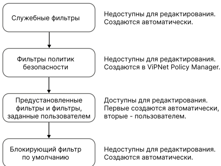
Рисунок 32. Последовательность применения сетевых фильтров
