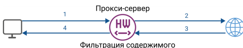
Рисунок 57. Схема работы прокси-сервера ViPNet Coordinator HW
