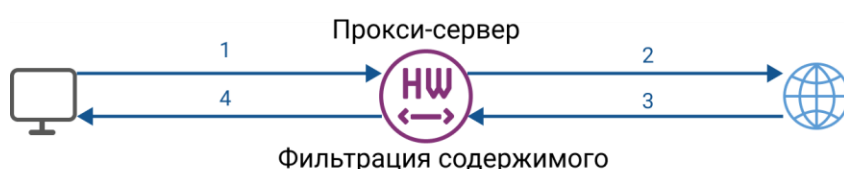
Рисунок 31. Схема работы прокси-сервера ViPNet Coordinator HW
