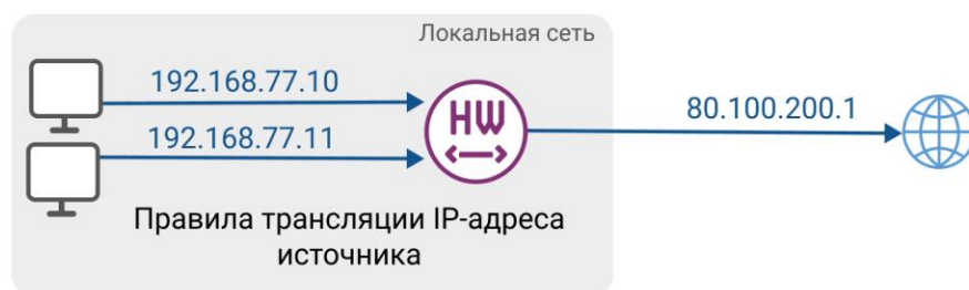
Рисунок 25. Организация доступа в интернет при помощи правила трансляции IP-адреса источника
