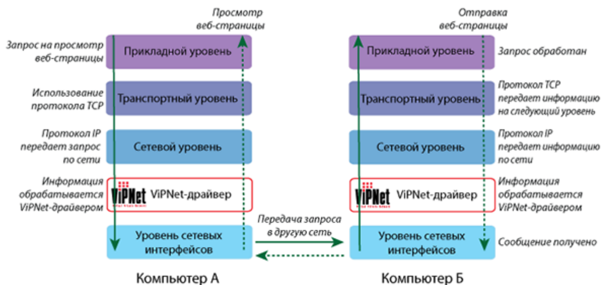
Рисунок 2. Схема работы сети TCP/IP, защищённой ПО ViPNet
