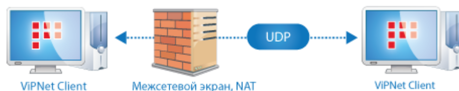
Рисунок 30. Сетевые узлы соединяются через межсетевой экран
