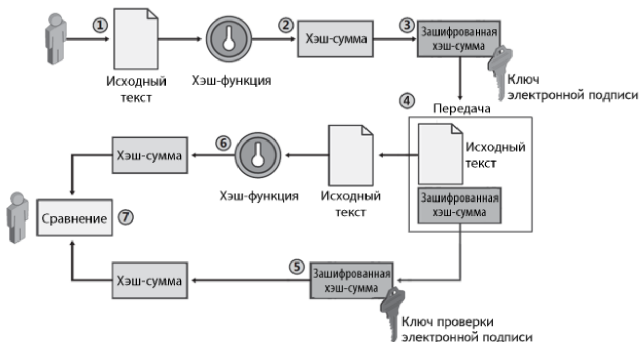
Рисунок 152. Применение хэш-функции и асимметричного криптографического алгоритма в электронной подписи
