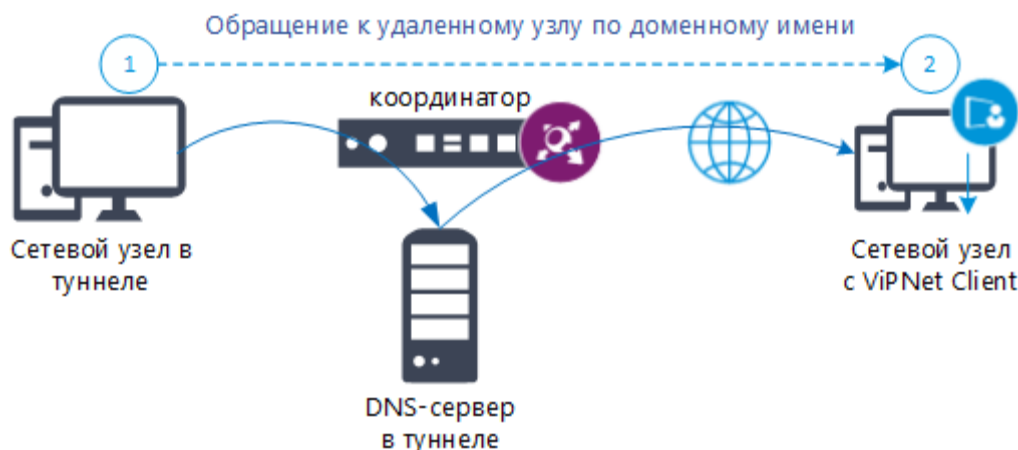
Рисунок 44. Схема расположения сетевых узлов и DNS-сервера
