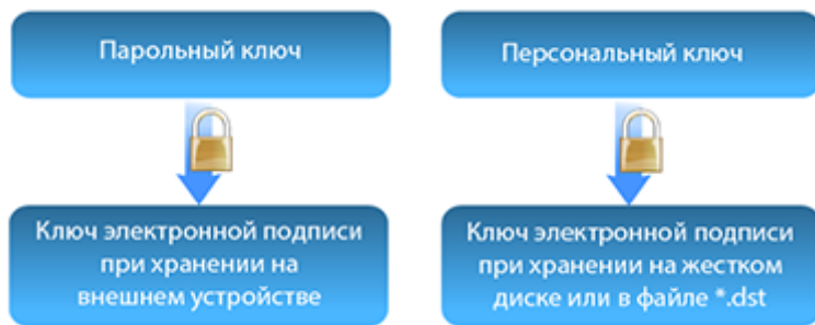
Рисунок 166. Схема защиты ключа электронной подписи
