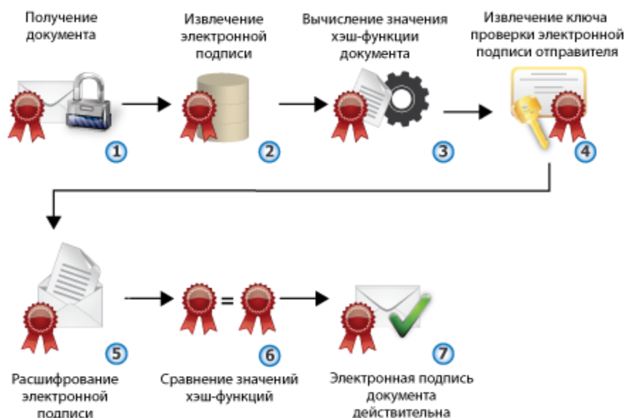
Рисунок 161. Процесс проверки электронной подписи документа
