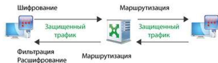
Рисунок 3. Обмен информацией между узлами ViPNet Client
