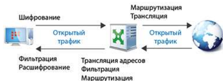
Рисунок 4. Обмен информацией между узлом ViPNet Client и Интернетом
