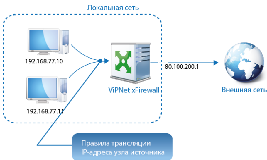
Рисунок 8. Организация доступа в Интернет при помощи правила трансляции IP-адреса источника
