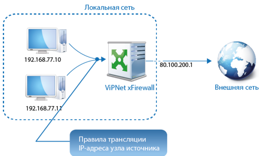
Рисунок 49. Организация доступа в Интернет при помощи правила трансляции IP-адреса источника
