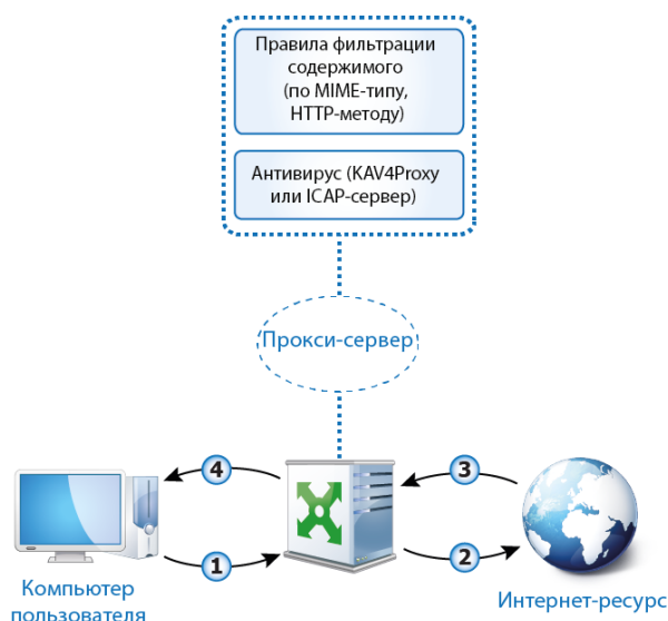
Рисунок 60. схема фильтрации HTTP-трафика прокси-сервером ViPNet xFirewall
