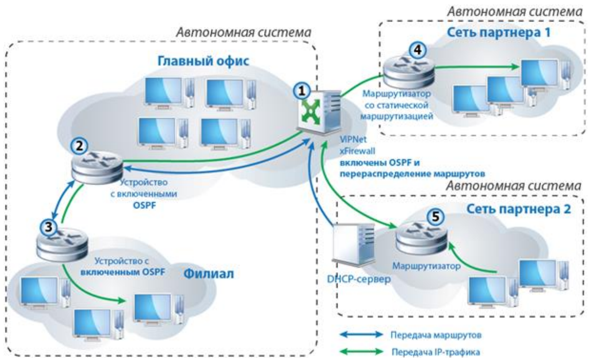
Рисунок 85. Схема взаимодействия автономных систем
