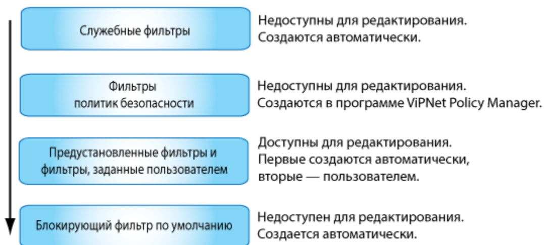
Рисунок 31. Последовательность применения сетевых фильтров
