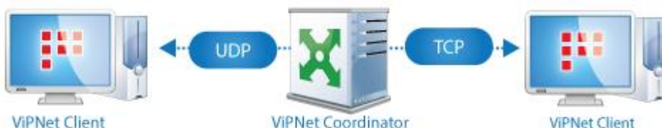
Рисунок 7. Сетевые узлы соединяются через межсетевой экран
