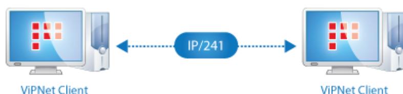
Рисунок 5. Сетевые узлы расположены в одном сегменте локальной сети
