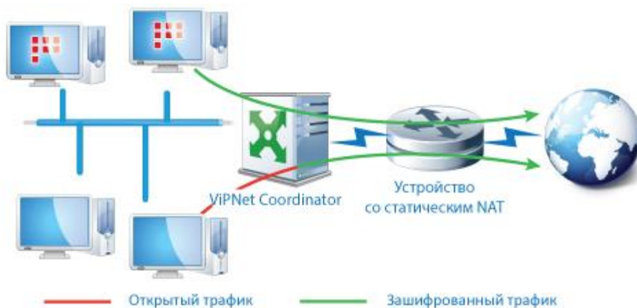
Рисунок 12. Подключение координатора через межсетевой экран со статической трансляцией адресов
