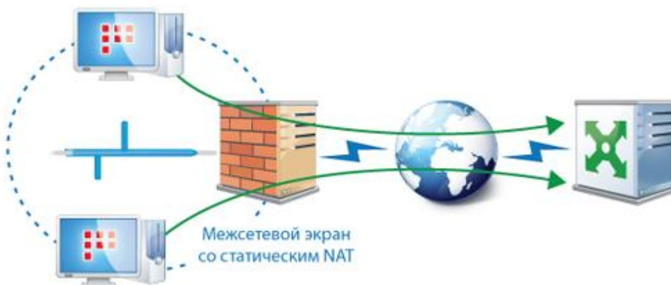
Рисунок 13. Подключение клиента через межсетевой экран со статической трансляцией адресов
