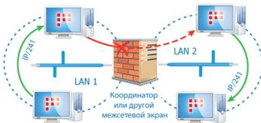
Рисунок 8. Подключение без использования межсетевого экрана на клиентах
