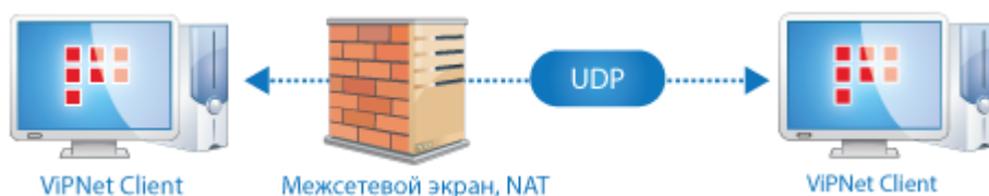
Рисунок 6. Сетевые узлы соединяются через межсетевой экран
