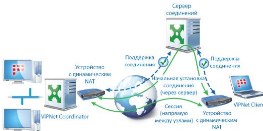
Рисунок 11. Подключение через межсетевой экран с динамической трансляцией адресов
